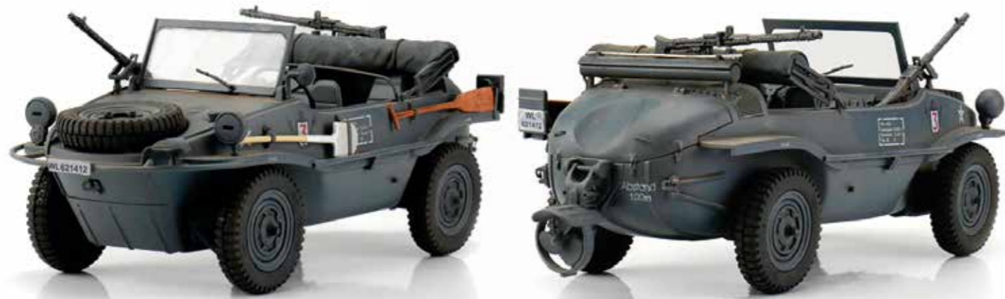
Bei der Auslieferung des VW Schwimmwagen Typ 166 kam es zu Verzögerungen, die nicht nur der aktuellen Situation, sondern auch Problemen bei Konstruktion und Funktionalität des Schraubenantriebs geschuldet waren
